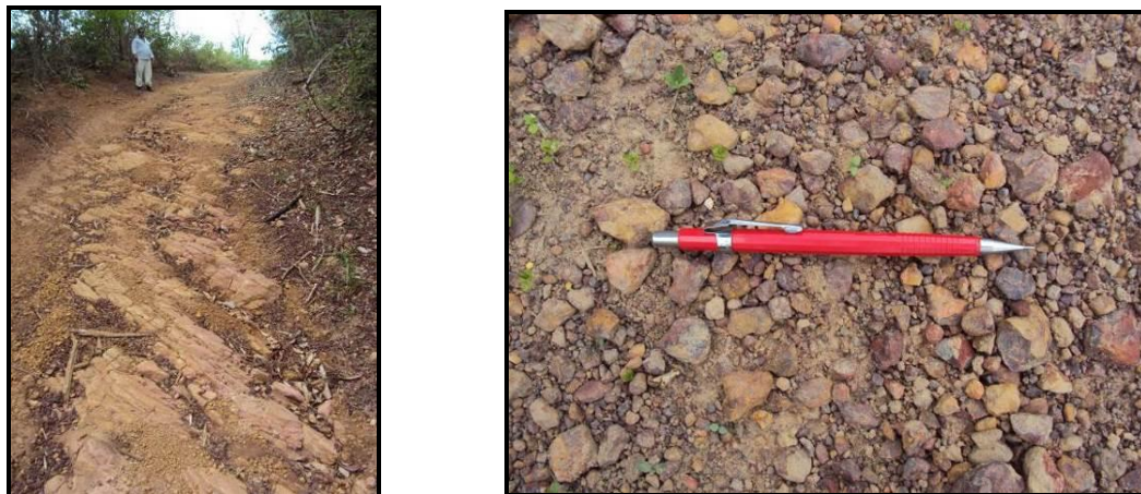
Figura 4.11. Afloramento de arenito com o acamamento sub-horizontal (Ponto C040 - Quadro 4.1) - à esquerda; fragmentos de concreções limoníticas ferruginosas (Ponto C010 - Quadro 4.1) - à direita. Fotos: CARUSO JR, 2013.
