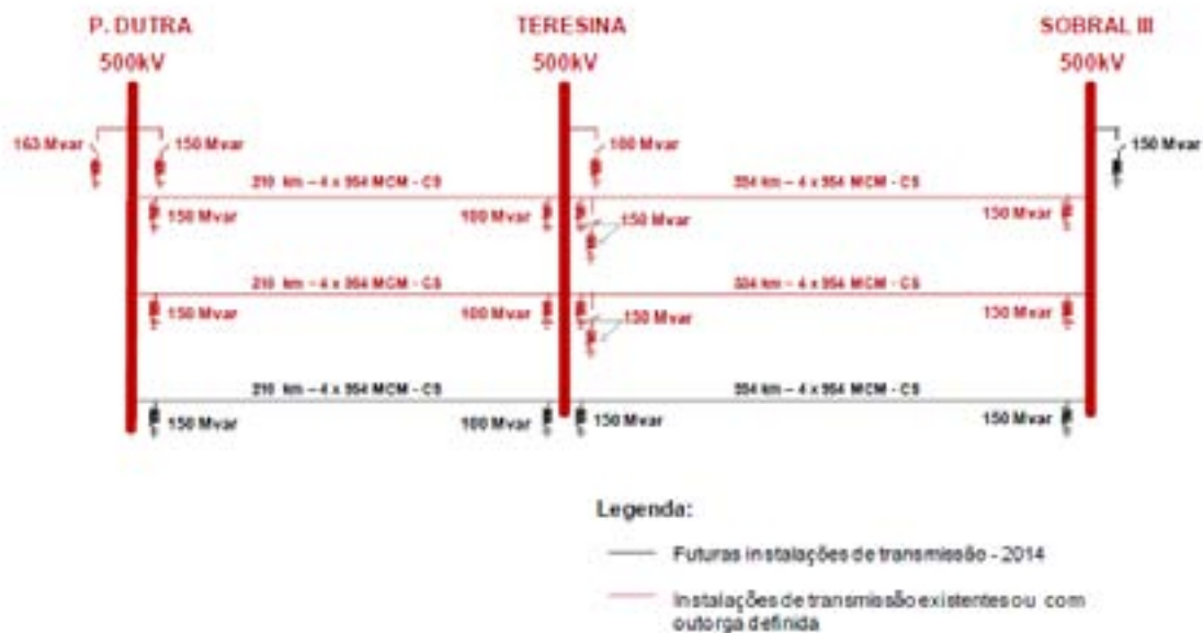
Figura 4.7. Trecho em 500 kV da LT P. Dutra - Teresina II - Sobral III C3 e SEs Associadas. Fonte: Análise técnico-econômica das Alternativas - Relatório R1 - Estudo para ampliação das interligações para o nordeste frente à necessidade de exportação do excedente de energia (EPE, 2011).
