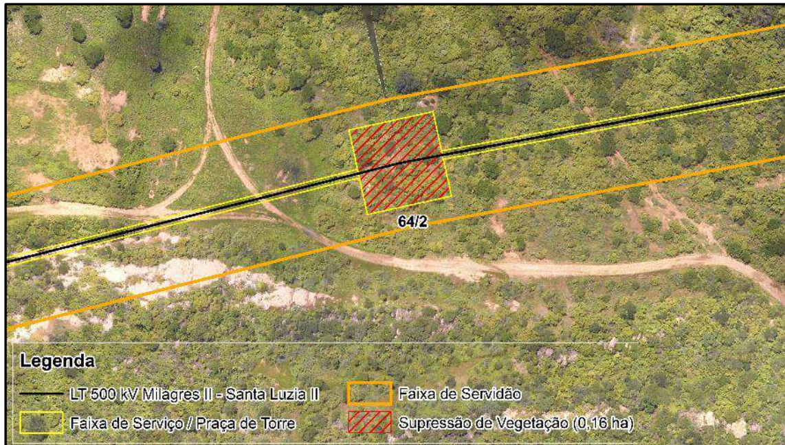
Figura 7 – Locação da praça da torre 64/2, em vértice, inserida em fragmento de vegetação nativa.
