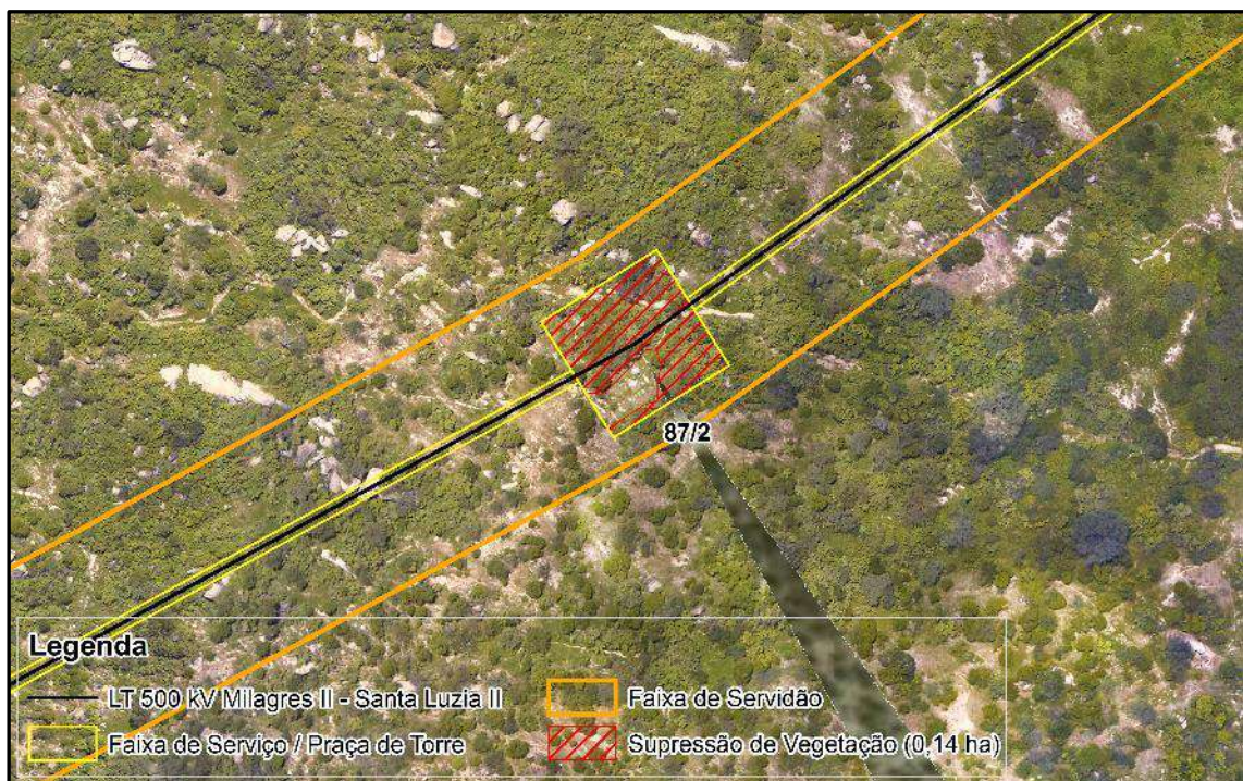
Figura 8 – Locação da praça da torre 87/2, em vértice, inserida em fragmento de vegetação nativa.
