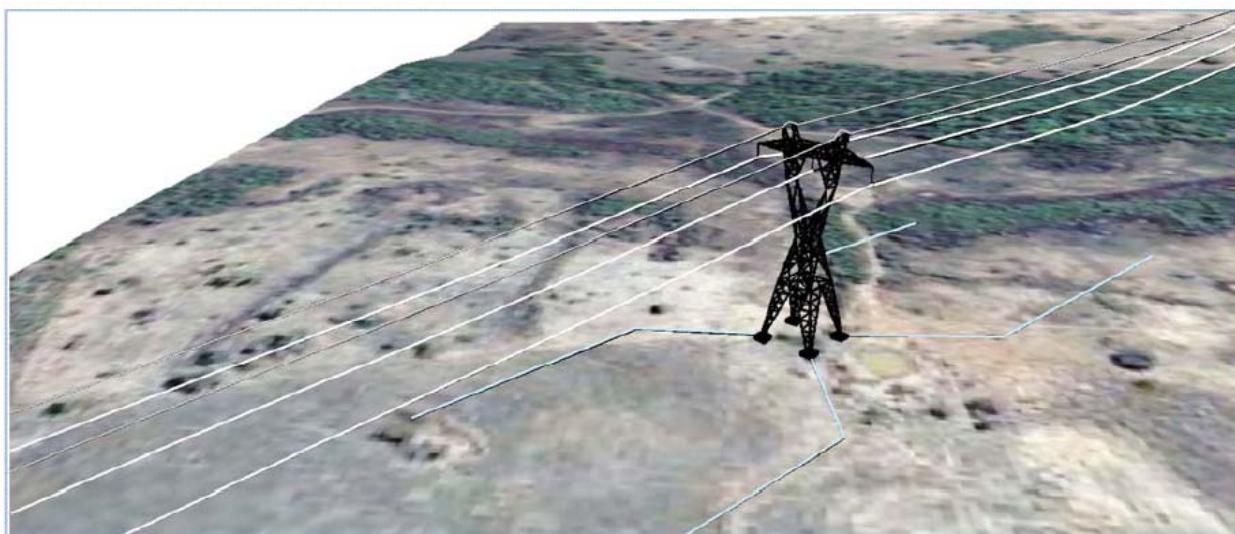
Figura 3.2.7.1-1 – Esquema de cabo contrapeso
