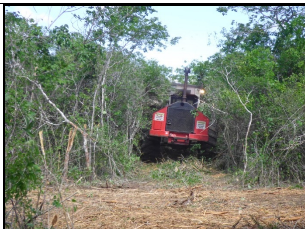
Foto 3-4 - Supressão mecanizada com o maquinário Prentice (desbastador florestal)
