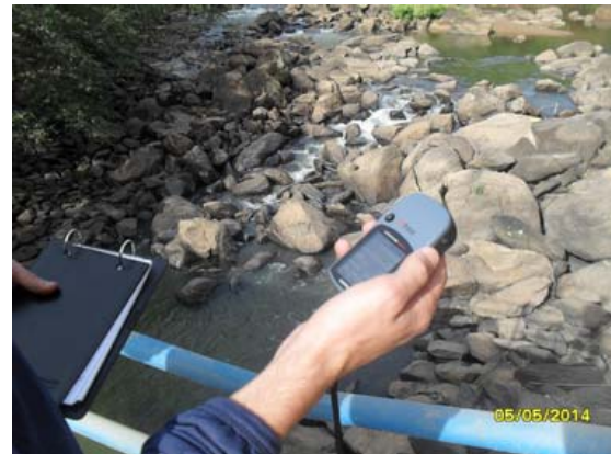
Figura 14 - Georreferenciamento com GPS de um ponto de observação em campo.
