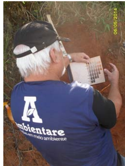
Figura 2 - Determinação da cor do solo com a Carta de Munsell.
