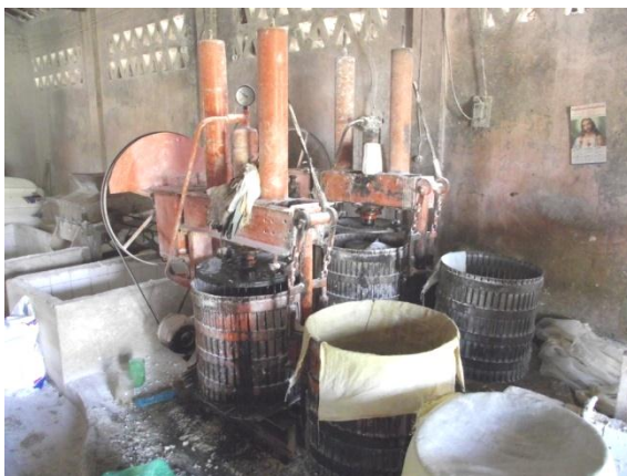
Prensa elétrica para retirada do ácido cianídrico.
