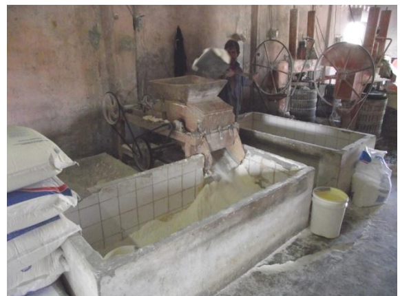
Prensa elétrica para retirada do ácido cianídrico.
