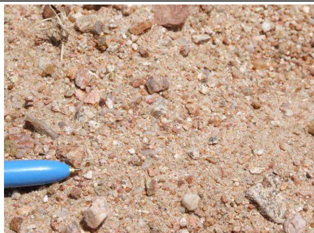
Foto 05 e 06: Fragmentos angulosos de quartzo e rochas, areia grossa e média que constituem sedimentos aluviais em canal fluvial de escoamento sazonal, que caracterizam os terrenos Aplanados na LT 500 kV Luiz Gonzaga – Garanhuns.
