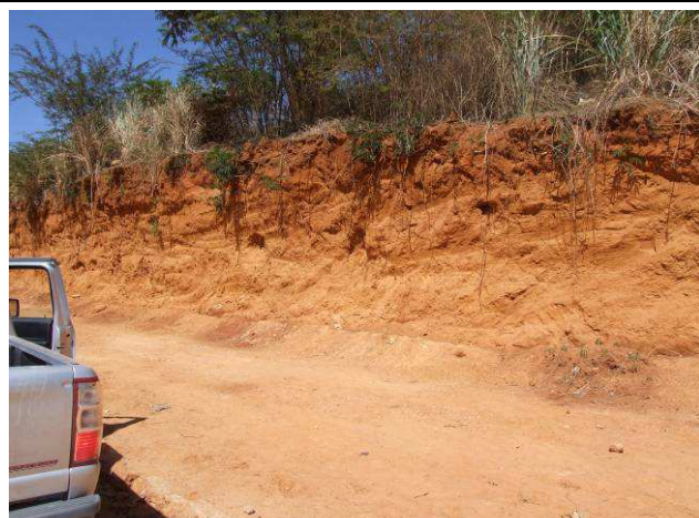
Fotos 133 e 134: Solo residual e solo de alteração argilo-arenoso bem desenvolvido nos terrenos Amorreados Rochosos na LT 500 kV Luiz Gonzaga - Garanhuns, o que é favorecido pela maior umidade que ocorre nesses terrenos.
