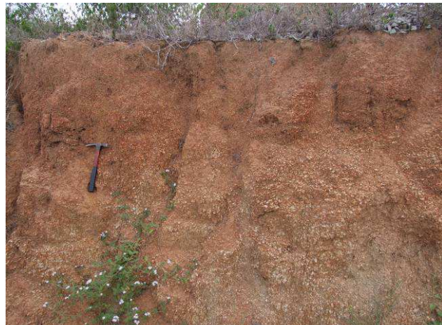
Fotos 43 e 44: Solo residual, raso, areno argiloso rico em cristais de quartzo e feldspato semi-alterados (arena), sobre horizonte de alteração de granito calcialcalinos de alto K, metaluminosos, grossos a porfíricos da Suíte Intrusiva Itaporanga.
