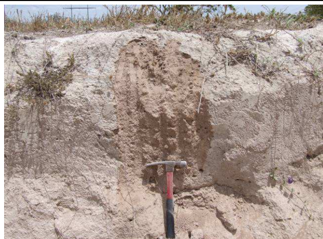
Foto 13: Solo residual constituído por areia média e grossa argilosa, com Grau de susceptibilidade a erosão Muito forte, que ocorre nos terrenos Aplanados, na LT 500 kV Garanhuns – Campina Grande III.
