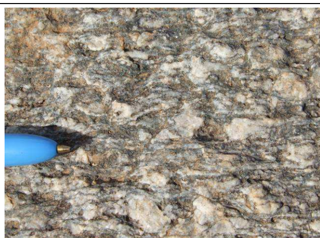
Fotos 111 e 112: Topo e encosta rochosa constituída por granito e granodiorito calcialcalinos de alto K, metaluminosos, grossos a porfíricos da Suíte Intrusiva Itaporanga, que caracterizam os terrenos Amorreados rochosos na LT 500 kV Garanhuns - Campina Grande III.
