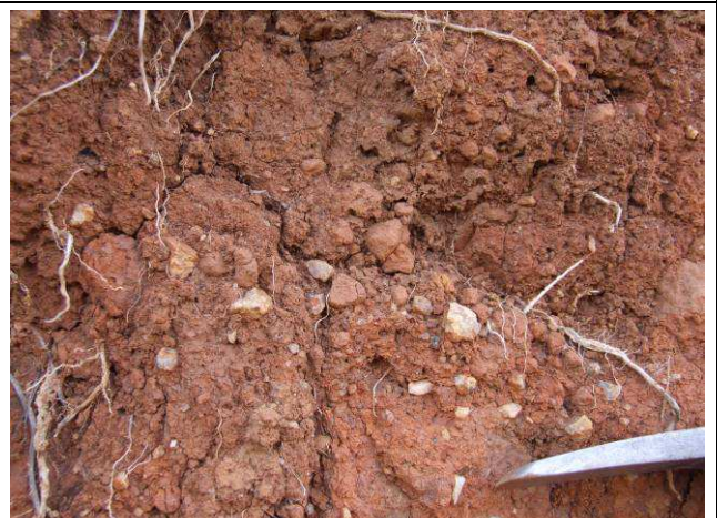
Fotos 71 e 72: Solo residual argiloso rico em grânulos e fragmentos de quartzo anguloso, espesso que ocorre no relevo de Colinas Pequenas e Morrotes, no Domínio Morfoclimático Tropical Úmido e caracterizam os terrenos Colinosos com Morrotes no (LT 500 kV Garanhuns – Pau Ferro).
