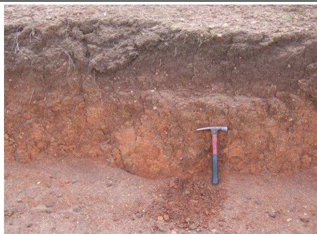
Fotos 71 e 72: Solo residual argiloso rico em grânulos e fragmentos de quartzo anguloso, espesso que ocorre no relevo de Colinas Pequenas e Morrotes, no Domínio Morfoclimático Tropical Úmido e caracterizam os terrenos Colinosos com Morrotes no (LT 500 kV Garanhuns – Pau Ferro).
