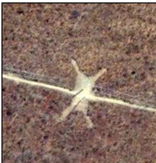
Figura 2.3.b: Exemplo de torre estaiada instalada e faixa de limpeza, com mínima supressão de vegetação (imagem de satélite)
