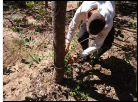
Figura 2.2.3.2-2 - Mensuração do diâmetro realizada na altura da base – DAB (diâmetro a 30 cm do solo).
