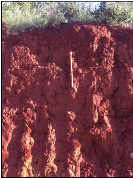
Figura 2.2.2.8-9 - Perfil de Latossolo Vermelho distrófico, A proeminente, textura argilosa, relevo suave ondulado. (UTM: 760267 / 8416671).
