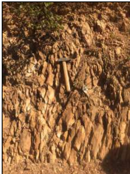
Figura 2.2.2.5-29 – (PONTO-GEOL-IJ-58) Formação Serra do Catuni (pEmsc) representado por um metassiltito suavemente dobrado. UTM (SIRGAS-2000: 689958 E / 8244438 N). Elevação: 609 m.
