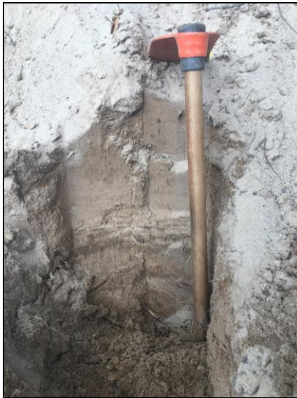
Figura 2.2.2.8-13 - Perfil de Neossolo Flúvico Tb distrófico, textura arenosa, relevo plano. (UTM: 601924 / 7944340).
