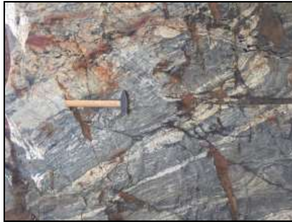
Figura 2.2.2.5-12 – (PONTO-GEOL-IJ-39) Complexo Porteirinha (A3p) representado por um biotita gnaiss com bandamento migmatítico e apresentando falhas e fraturas. UTM (SIRGAS-2000: 726119 E / 8336608 N). Elevação: 619 m.
