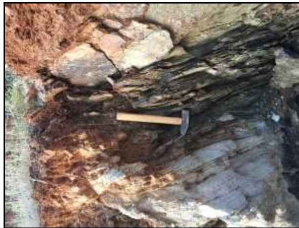
Figura 2.2.2.5-11 – (PONTO-GEOL-IJ-04) Complexo Santa Isabel (A34sig) apresentando granito-leucognaisse com níveis de biotita-gnaisse com veios de quartzo deformado. UTM (SIRGAS-2000: 752632 E / 8367749 N). Elevação: 557 m.
