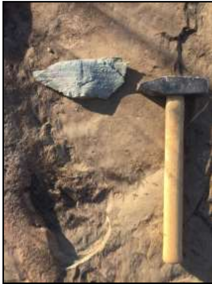
Figura 2.2.2.5-27 - (PONTO-GEOL-IJ-27) Formação Serra do Boqueirão, Grupo Santo Onofre (MP3ob) apresentando filito/xisto e quartzito fraturado sub-vertical, além de níveis de sericita-xisto. UTM (SIRGAS-2000: 761268 E / 8368162 N). Elevação: 972 m
