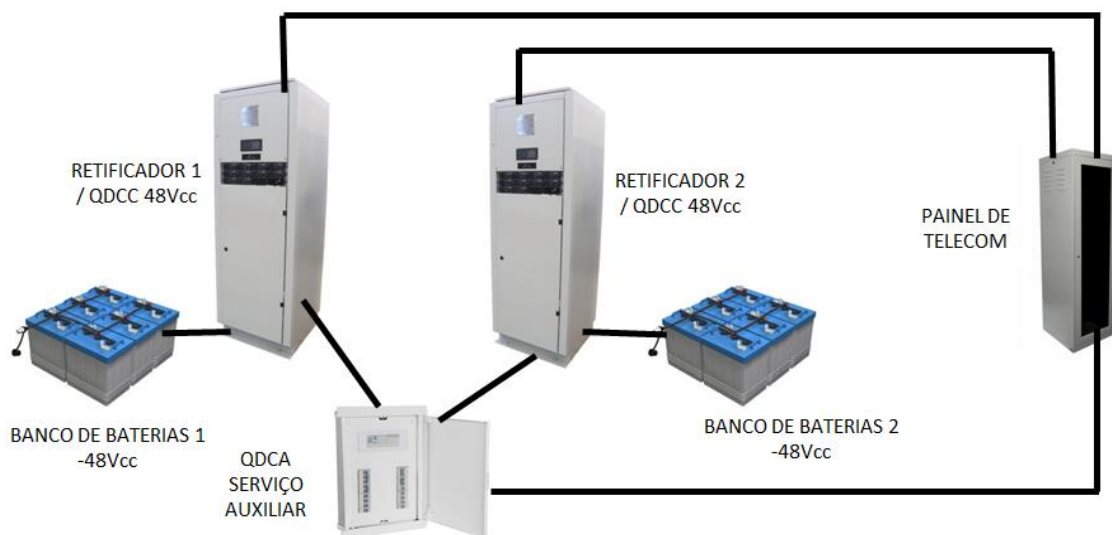
Figura 6 - Sistema de Alimentação -48Vcc para Telecomunicações
