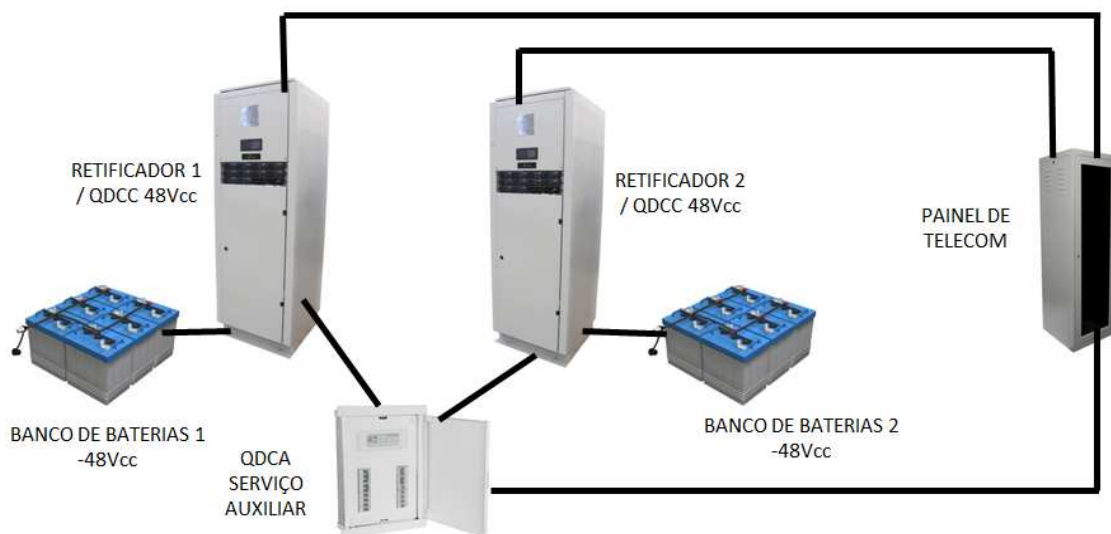
Figura 6 - Sistema de Alimentação -48Vcc para Telecomunicações
