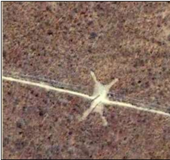
Figura 1.4-9 - Croqui e imagem aérea de supressão para implantação de torre estaiada.
