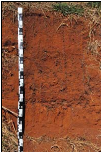
Figura 3.2.8-15 - Perfil de Latossolo Vermelho eutroférico em relevo de morrotes sobre o Complexo Varginha-Guaxupé Município: Arceburgo - MG Coord. UTM/SIRGAS-2000/F23 E: 303.773 N: 7.641.584
