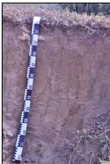
Figura 3.2.8-9 - Perfil de Latossolo Bruno distrófico em relevo suave ondulado sobre rochas da formação Serra Geral Município: Ibiraci - MG Coord. UTM/SIRGAS-2000/F23 E: 272.397 N: 7.730.454
