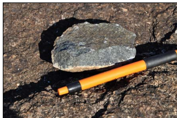
Figura 3.2.5-11 - Detalhe de rocha máfica, possivelmente anfibolítica maciça e de cor levemente esverdeada. (Coordenadas UTM 23S 329.065/7.549.319).
