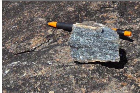
Figura 3.2.5-16 - Detalhe de amostra de granulito melanocrático com grandes cristais de feldspato cinza esfumado de até 1 cm, aparentemente orientados em uma direção preferencial. (Coordenadas UTM 23S 307.281/7.633.014).
