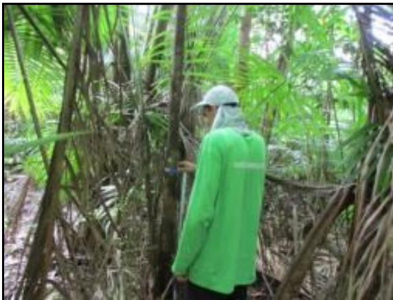
Figura 2.2.3.2-3 - Mensuração do diâmetro realizada na altura do peito - DAP (diâmetro a 1,30 m do solo).
