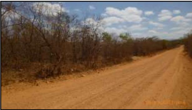
Figura 1 - Exemplo de acessos encontrados - estrada municipal com recobrimento de piçarra.
