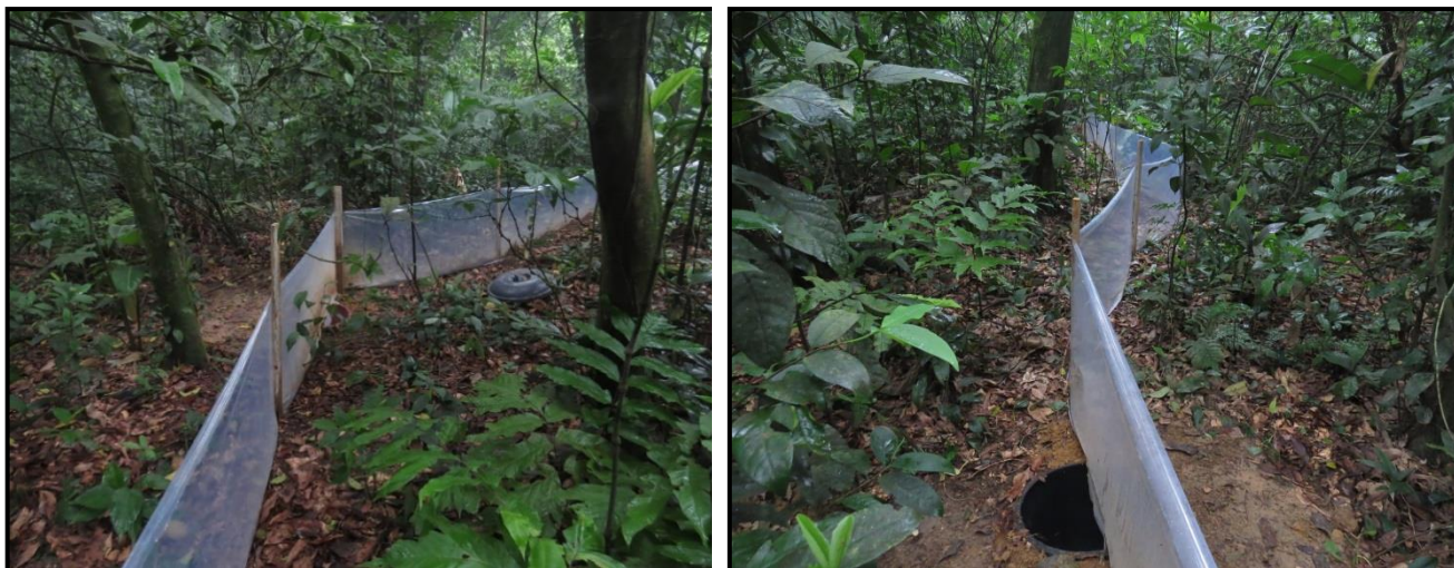
Figura 5. Armadilhas de interceptação e queda ( pitfalls ) instaladas para o diagnóstico da herpetofauna.
