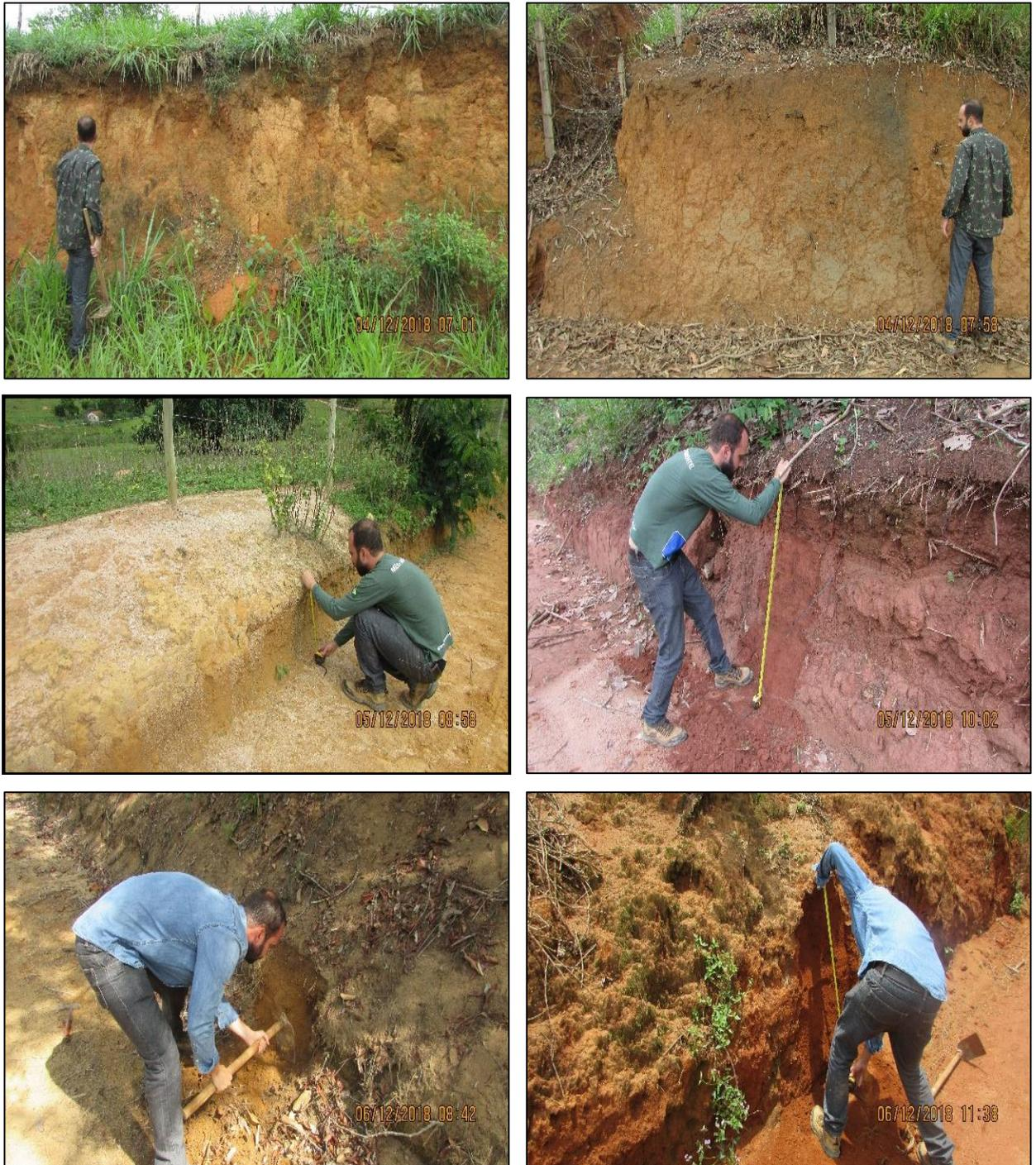
**Figura 94 - Coleta de amostras para análises físico-químicas do solo na AE e ADA da LT**
