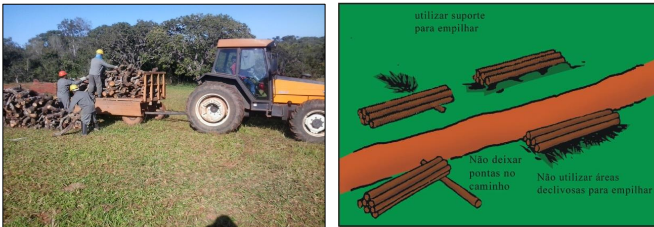
Figura 5. Trator e implemento para arraste (direita) e empilhamento de Toras de Madeira. Fontes: Cymi. e Amaral, 1998.
