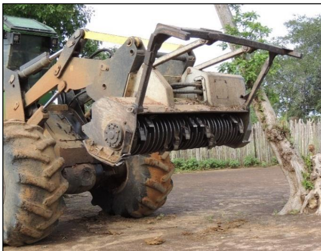
Figura 6. Detalhe do implemento DAF (esquerda) e equipamento acoplado ao implemento DAF realizando a supressão mecanizada de faixa de serviço. Fonte: Cymi.
