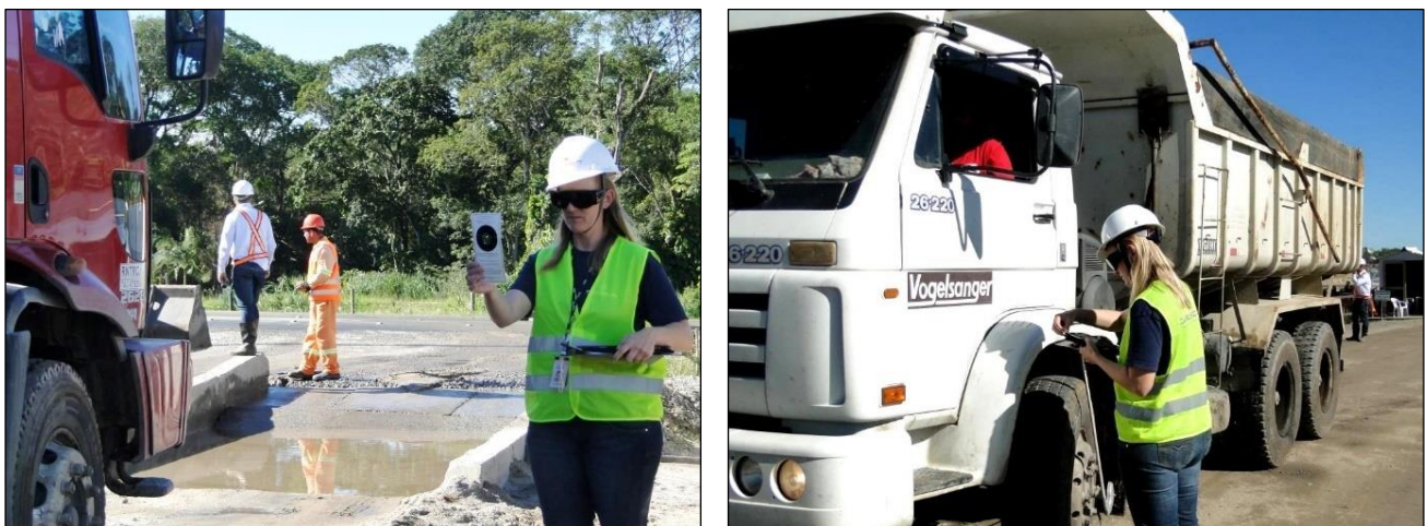
Figura 1. Aplicação da escala Ringelmann em veículos e equipamentos.
