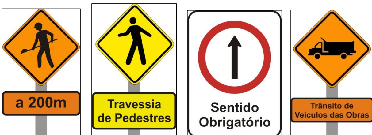
Figura 5. Modelos de placas de sinalização sugeridas para instalação nas proximidades do Pátio de Dom Inocêncio/PI.
