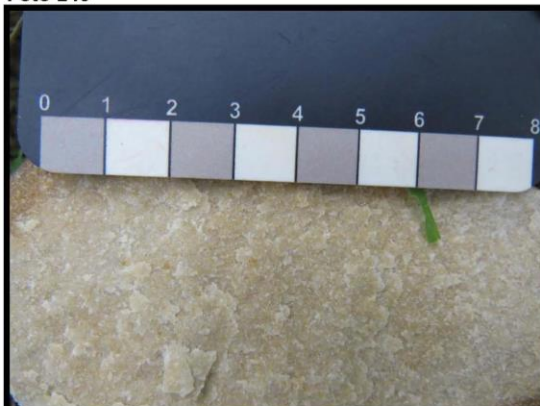
Ponto 099 UTM 24M X: 215555 Y: 9633844 Detalhe de arenito silicificado em superfície provenientes do Grupo Serra Grande
