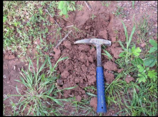
Ponto 014 UTM 23M X: 772486 Y: 9447777 Litossolo laterítico com matriz arenosa e granulometria fina à muito fina
