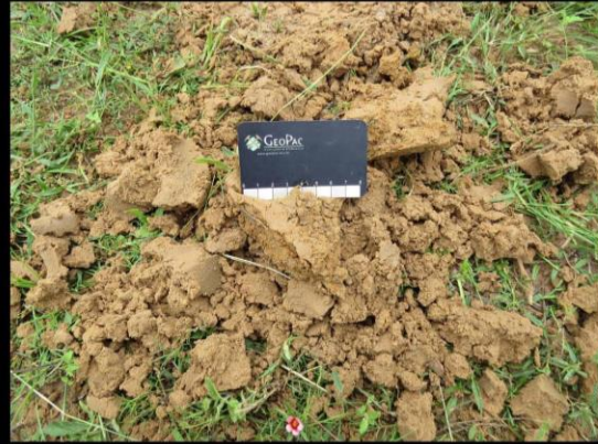
Ponto 027 UTM 23M X: 822228 Y: 9482251 Solo arenoso proveniente de intemperismo da Formação Cabeças
