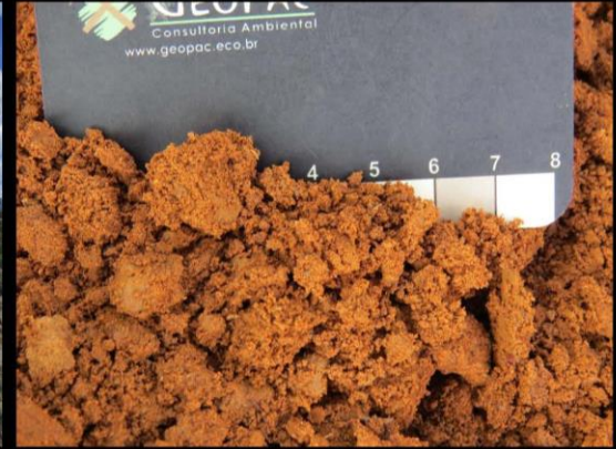
Ponto 074 UTM 24M X: 245657 Y: 9549136 Solo arenoso resultante de intemperismo de laterita
