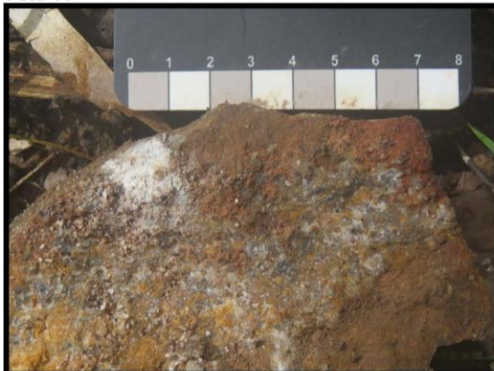
Ponto 005 UTM 23M X: 761875 Y: 9435703 Bloco de sílexito com óxido de ferro observado no ponto
