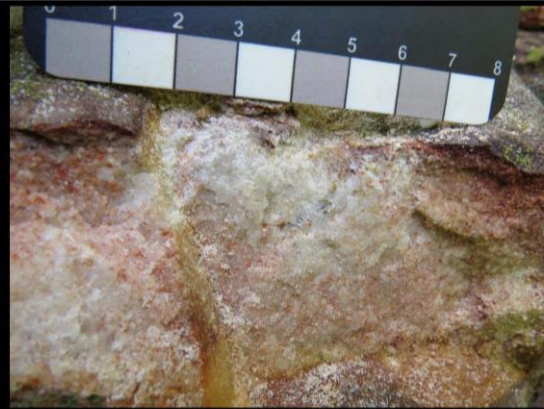
Ponto 091 UTM 24M X: 228565 Y: 9622181 Detalhe de quartzo recristalizado observado no afloramento
