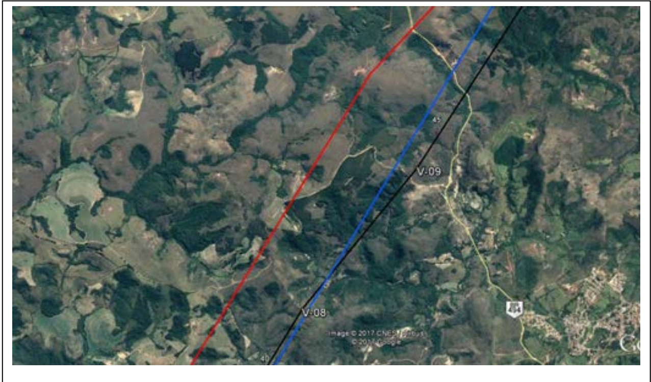
Figura 4-7 – Ajuste de traçado visando aproveitar acessos já abertos, e não afetar benfeitorias, entre o V08 e o V09.
