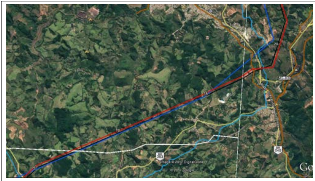
Figura 4-14 – Trecho da LT 345 kV Jeceaba – Itabirito 2, passando ao norte da localidade de Alto Maranhão. As diretrizes das Alternativas I e II , entre o Km 5 e o Km 15, são coincidentes. Do Km 15 ao Km 20 e mais adiante, as diretrizes das Alternativas II e III seguem à direita, para desviar de vegetação arbórea e buscar o melhor local para a travessia da ferrovia e, logo em seguida, da BR-040. A seguir, afasta-se da área de expansão do distrito-sede de Congonhas.
