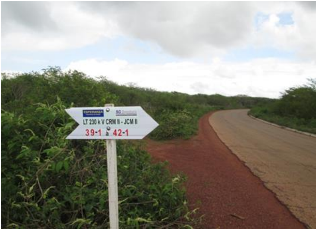
Figura 1.4-34 – Exemplo de placa de sinalização de LT existente, indicando a numeração das torres.
