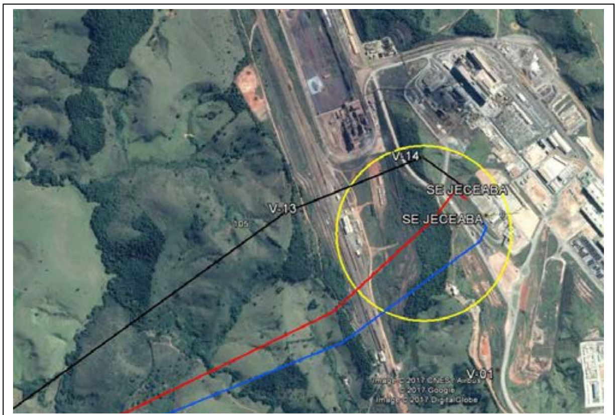
Figura 4-11 – A mudança visou minimizar interferências em benfeitorias (Km 86 e Km 87) e na altura do Km 91 (V11), o afastamento do vetor de expansão de Entre Rios de Minas.
