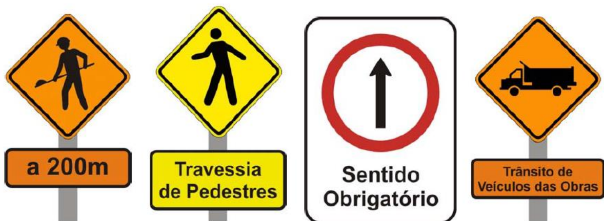
Figura I-1 – Placas para orientações do trânsito nos canteiros de obras e acessos.
