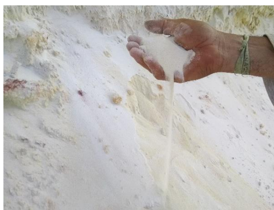
Foto 5.2.2-12: Caracterização de arenito lítico, bem selecionado, de granulação fina, correlacionado a Formação São Domingos. Coord.: 23 K 774371.36 m E 8144482.87 m S.
