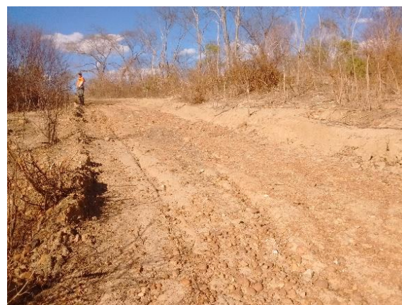
Foto 5.2.4-30: Erosão linear rasa. Coord. 23 K 748487.00 m E 8184076.00 m S
