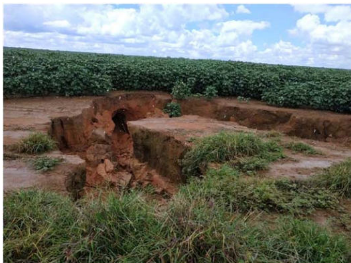
Foto 6.1-13: erosão em pipe no eixo da LT Sob monocultura de algodão. Lat 11° 44'58.87"S / Long 46° 5'7.13"O
