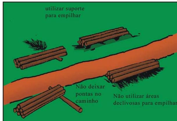
Figura 2.5-18 - Empilhamento de toras de madeira. Detalhes dos tipos de suporte para aeração da madeira empilhada e recomendações para evitar acidentes
