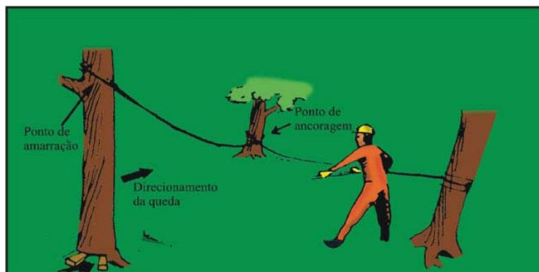
Figura 2.5-9 - Ilustração da técnica de ancoragem, onde podem ser combinadas as utilizações de cunha, de tirfor e de assimetria na largura da dobradiça
