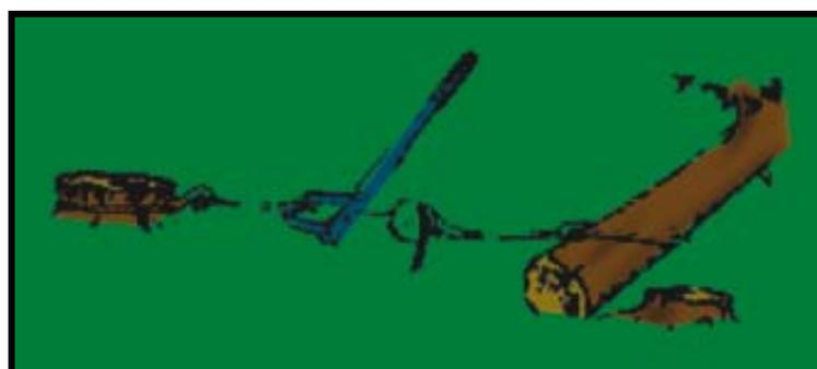
Figura 2.5-6 - Redirecionamento da queda da árvore através da adoção de cunha e assimetria na largura da dobradiça/utilização do tirfor no redirecionamento da queda da árvore
