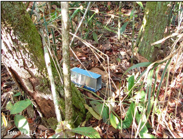
Figura 1-94 - Armadilha para captura de animal vivo de alumínio (25cm de comprimento x 9,5cm de altura x 7,5cm de largura)
