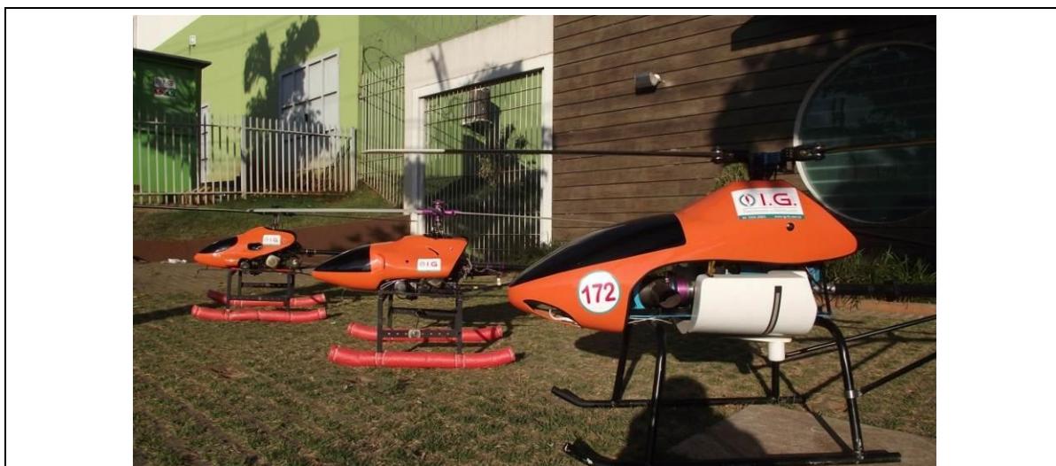
Figura 2.2-2 Aeromodelos utilizados no lançamento de cabos pilotos.
