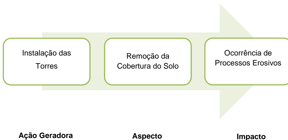
Figura 132: Exemplo de Rede de Interações em atividade de terraplanagem.
