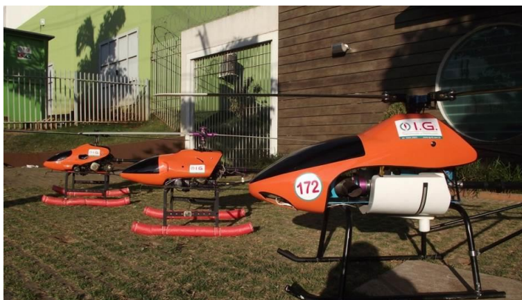
Figura 9: Aeromodelos / Drones utilizados no lançamento de cabos pilotos.
