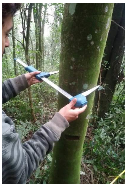
Figura 80: Coleta de dado a campo, diâmetro a altura do peito (DAP).
