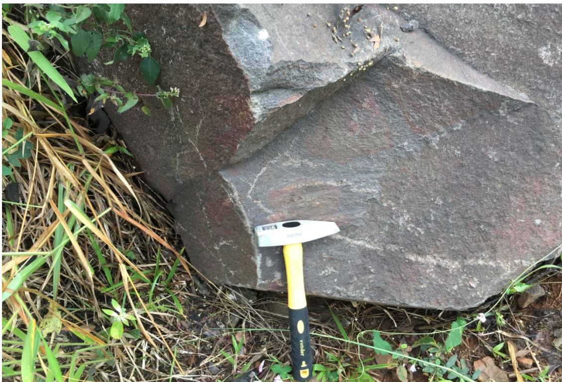
Figura 35: Detalhe da fotografia anterior com características da rocha riodacítica mais sã.
