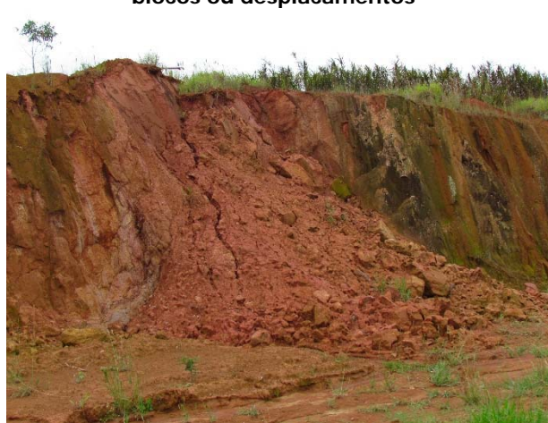
Foto 20 – Terrenos com Suscetibilidade Classe 3 – Argissolos, com frentes escarpadas com rocha aflorante com potencial de quedas de blocos ou deslocamentos
