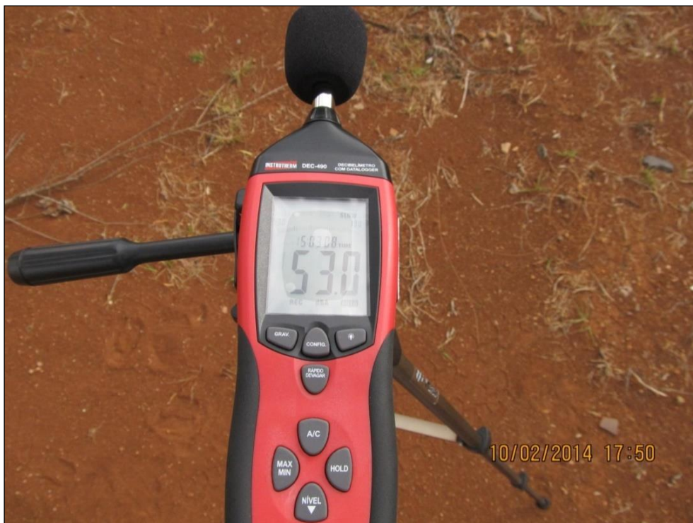
Figura 18 - Decibelímetro utilizado no monitoramento.
