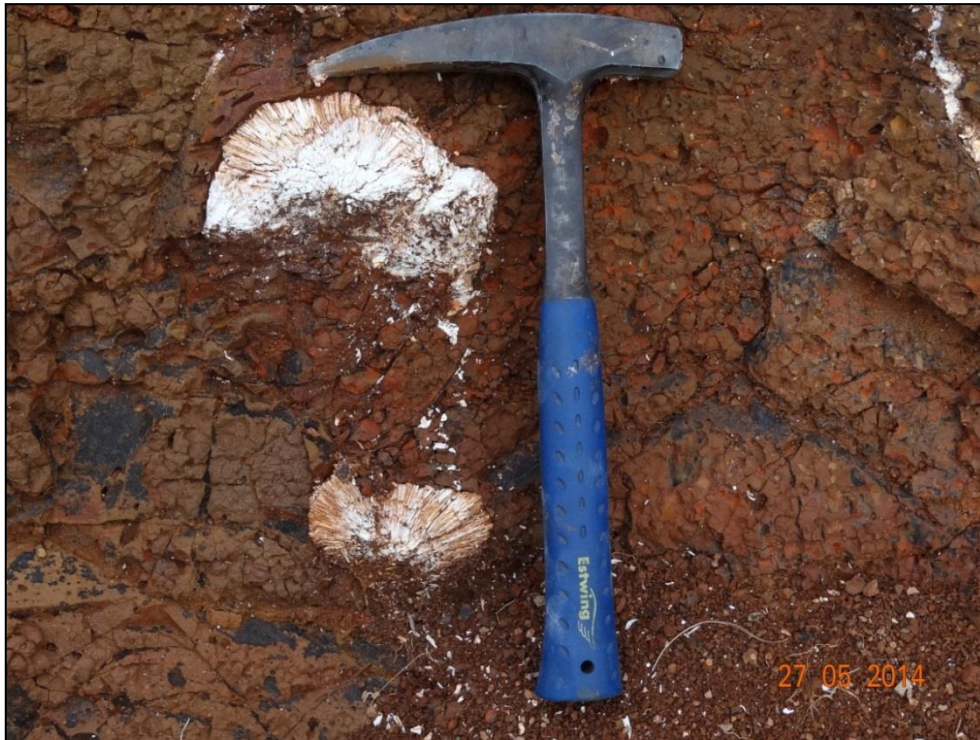
Figura 61 - Detalhe da zeolita (mineral) intemperizada em meio ao basalto também já bastante intemperizado.
