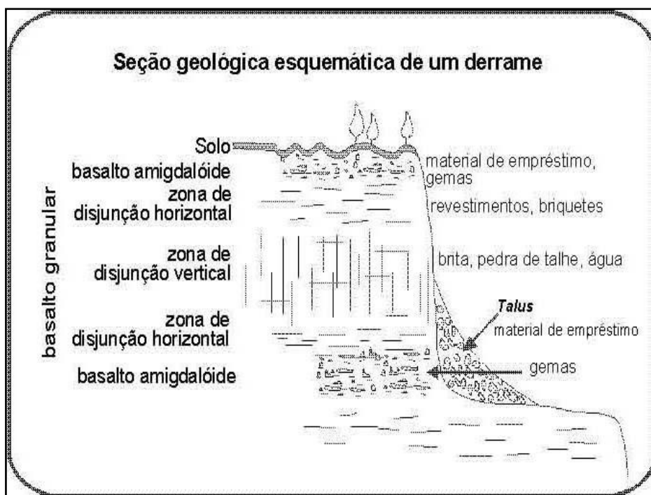
Figura 71 - Seção geológica esquemática da sequência básica de um derrame basáltico da Formação Serra Geral.
