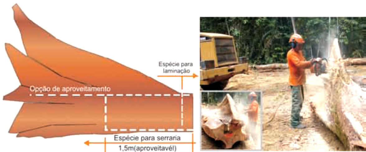
Figura 53. Retirada de Sapopemas e aproveitamento do fuste. Fonte: IFT (2011).
