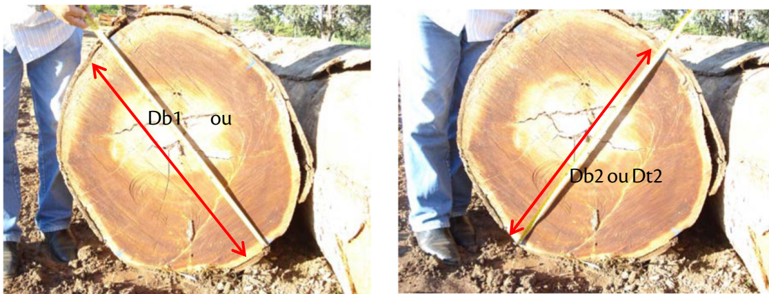
Figura 54. Medição dos diâmetros da base e topo da tora através da medição em cruz. Fonte: SBS (2012).
