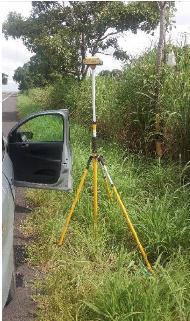
Figura 20. Estação base (GPS RTK) utilizada para posicionamento geográfico do VANT.
