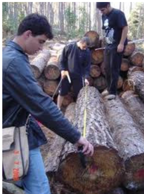
Figura 60. Medição do comprimento da tora ou tореte com fita métrica.
