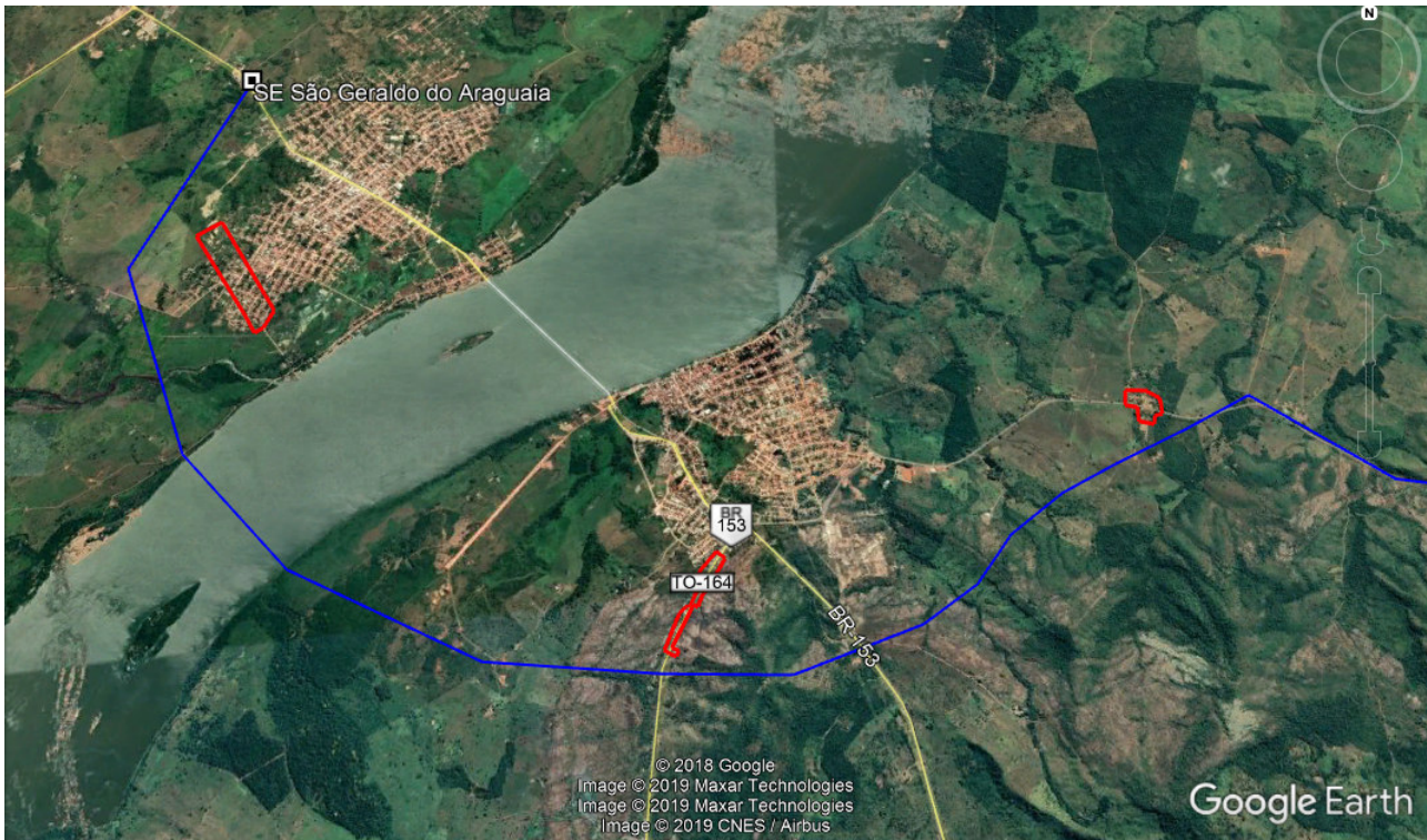
Figura 4. Alternativa 3 de traçado para a LD 138 kV Xambioá/São Geraldo do Araguaia. Destaque (em vermelho) para as regiões com adensamento de casas.
