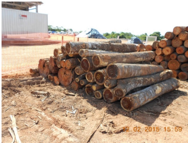
Figura 62 - Exemplo de empilhamento adequado das toras e toretas.
