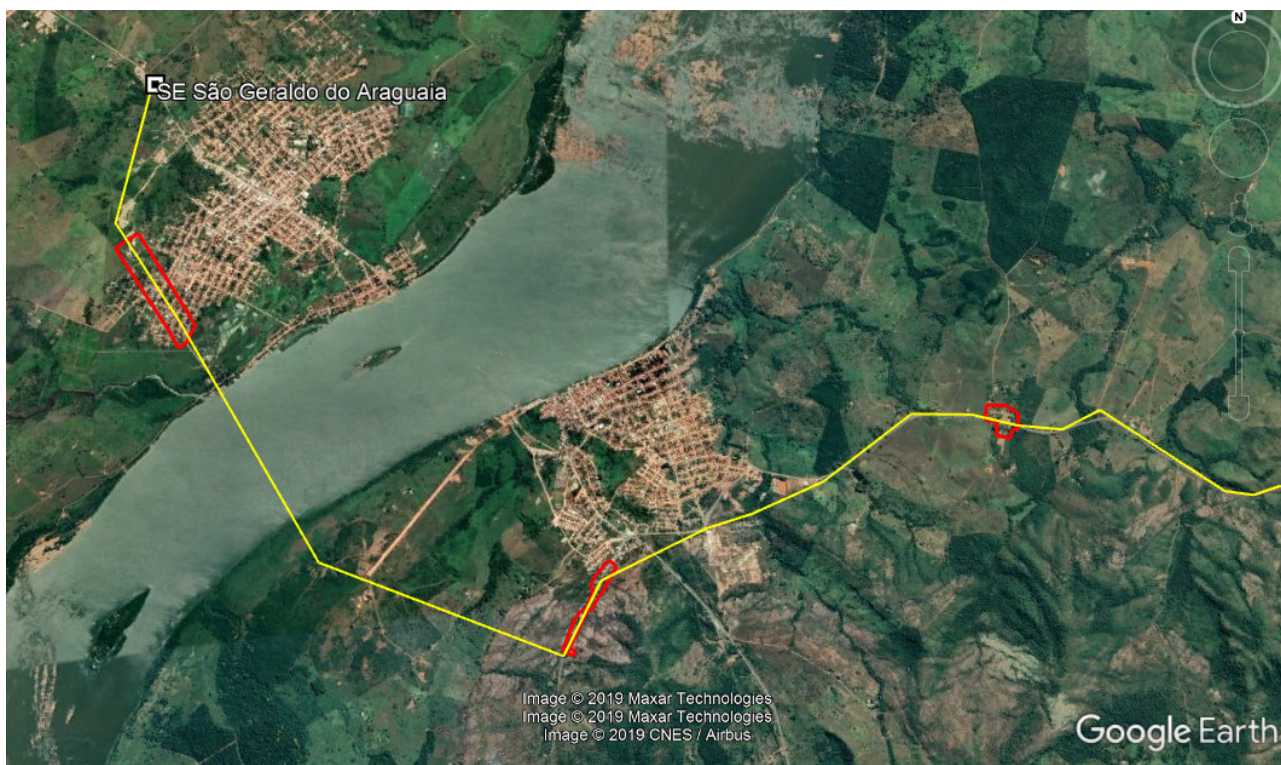
Figura 3. Alternativa 2 de traçado para a LD 138 kV Xambioá/São Geraldo do Araguaia. Destaque (em vermelho) para as regiões com adensamento de casas.
