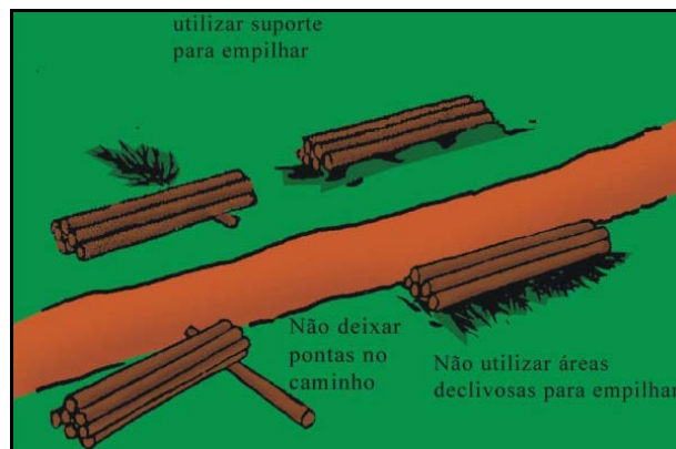
Figura 7-24 - Empilhamento de toras de madeira. Detalhes dos tipos de suporte para aeração da madeira empilhada e recomendações para evitar acidentes.
