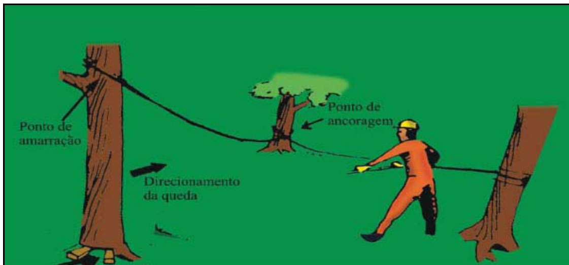
Figura 7-15 - Ilustração da técnica de ancoragem, onde podem ser combinadas as utilizações de cunha, de tifor e de assimetria na largura da dobradiça.
