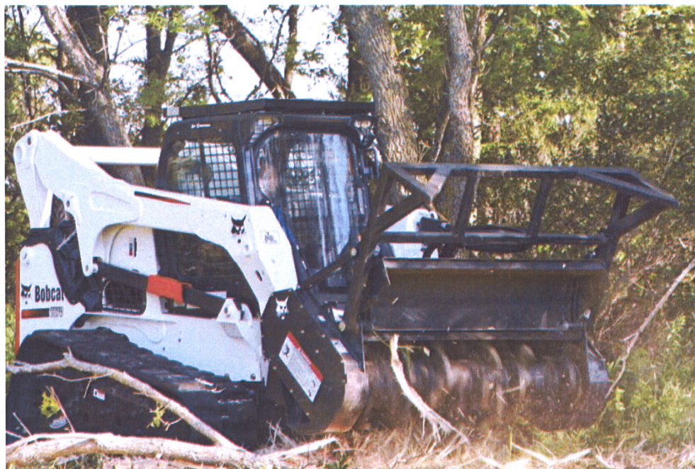
Figura 11 – Exemplo de desbastadora acoplada a uma máquina BobCat. Fonte: Cymimasa.
