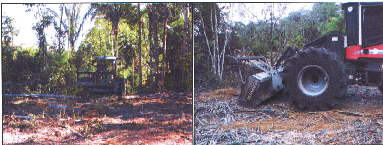
Figura 10 – Exemplo de desbastadora acoplada a uma máquina Prentice. Fonte: Cymimasa.
