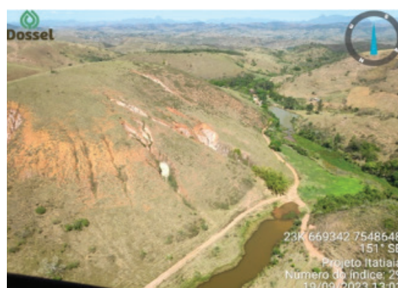
Voçoroca em meia encosta causada pela remoção da vegetação em área de alta declividade.
