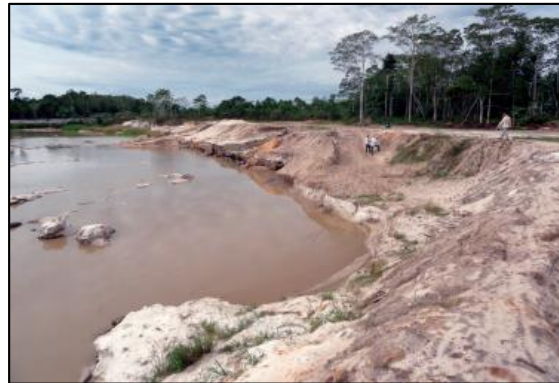
Figura 6.25 - Extração de areia para construção civil a partir do horizonte eluvial desenvolvido sobre superfície tabular, embasado por arenitos pouco consolidados da formação Içá (vicinal de terra no município de Mâncio Lima).
