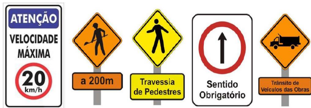
Figura 8.3 – Exemplos de placas para orientações do trânsito nos canteiros de obras e acessos.
