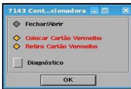
Figura 14 – Exemplo de tela de Comando do Seccionador no SAGE
