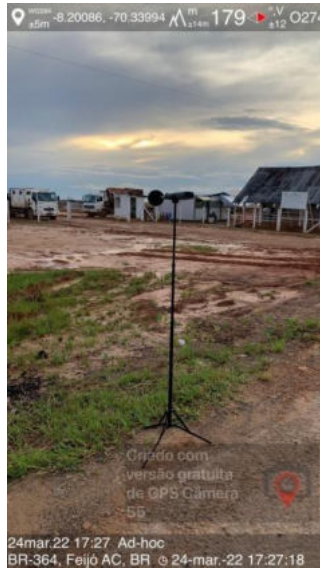
Figura 4: Medidor sonoro com protetor de vento
