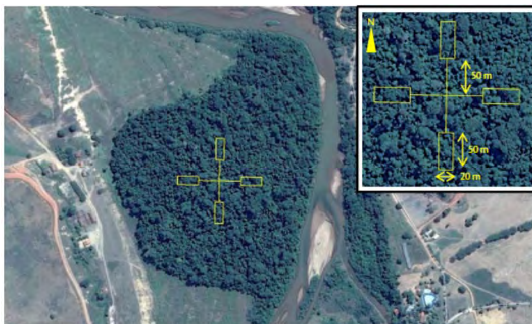
Figura 2. Modelo esquemático utilizado para o módulo conglomerado, formado por quatro subparcelas de 20 x 50 m.
