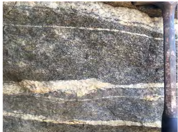
Figura 57. Detalhe do ortognaisse com bandas máficas (hornblenda, biotita, quartzo e feldspato) alternadas às félsicas (quartzo e feldspato).
