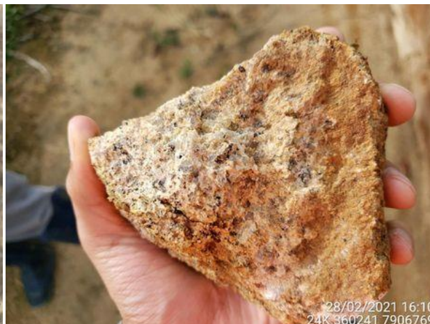
Foto 4.3-22: Granito equigranular, de granulação grossa, da Suíte Ataleia. A mineralogia principal é composta por quartzo, K-feldspato, biotita e granada.
