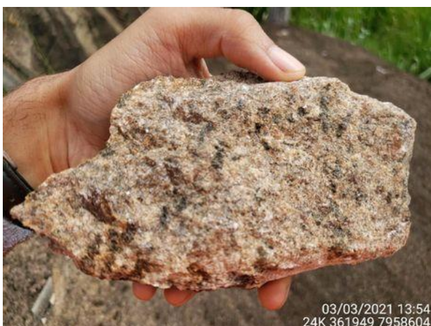
Foto 4.3-17: Rocha fraturada, com direção de mergulho no azimute 285° e ângulo de mergulho 70°. A rocha foi descrita como granitoide, inequigranular, contendo feldspato, quartzo, anfibólio e biotita.
