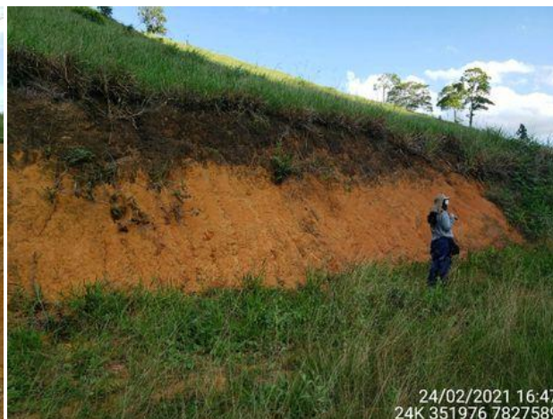
Foto 4.3-38: Espesso pacote de Latossolo Vermelho-Amarelo evoluído a partir do intemperismo de sedimentos aluvionares (Q2a).
