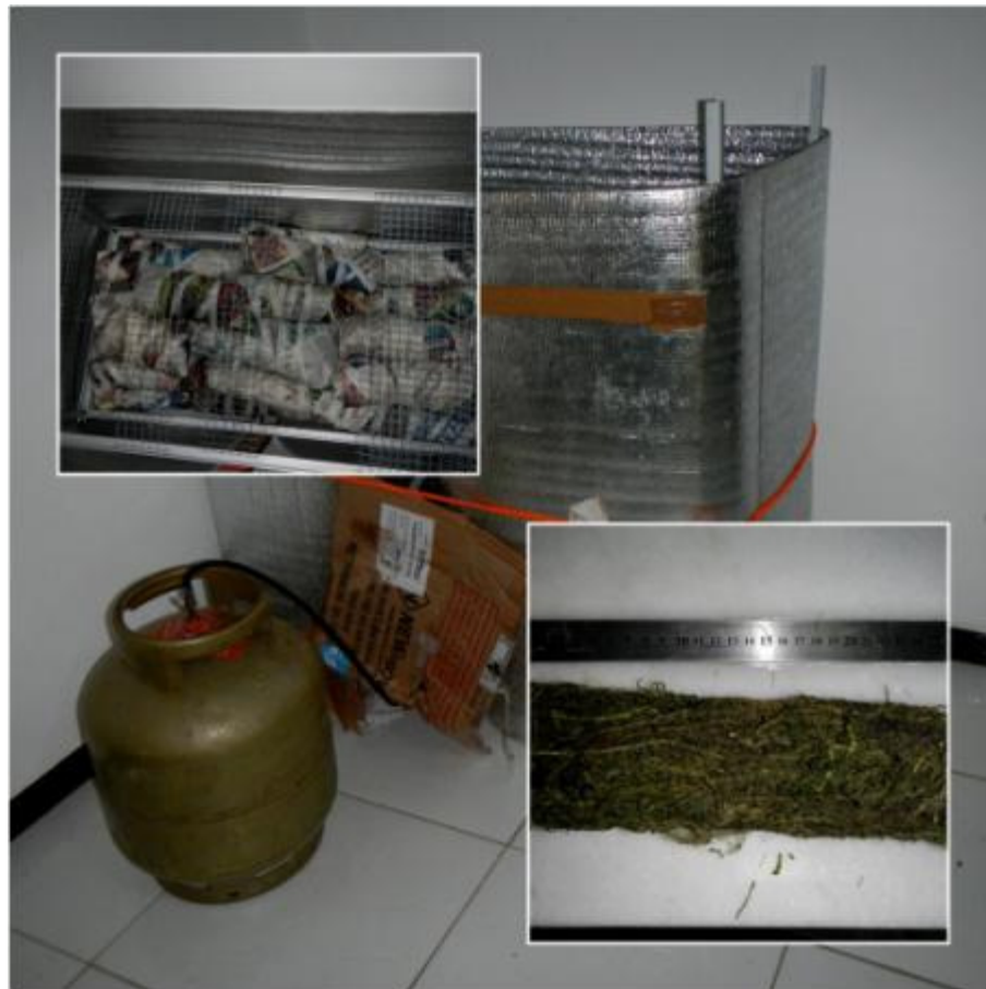
Figura 5-6. Estufa de secagem a gás, em detalhe, frações de macrófitas embaladas em jornais e separadas por espécies.
