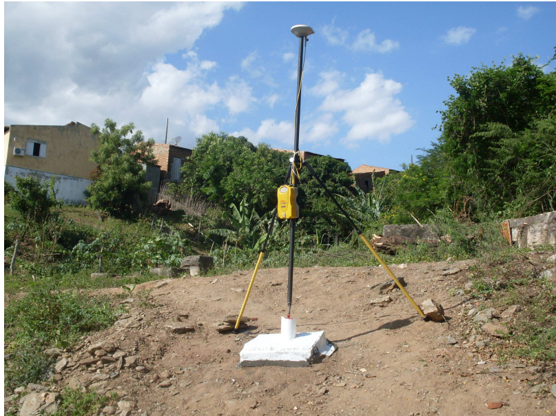
Foto 4 – Receptor GPS Trimble 5700 utilizado no georreferenciamento das RRNN.
