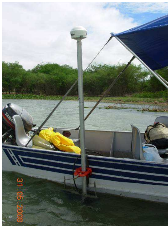
Foto 3 – Detalhamento da fixação do transdutor e da antena do DGPS no suporte de sustentação.
