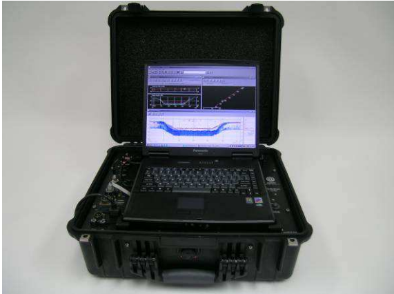
Fotos 1 e 2 - Equipamento EchoTrac CVM, Transdutor de alta frequência, utilizado durante os levantamentos batimétricos.
