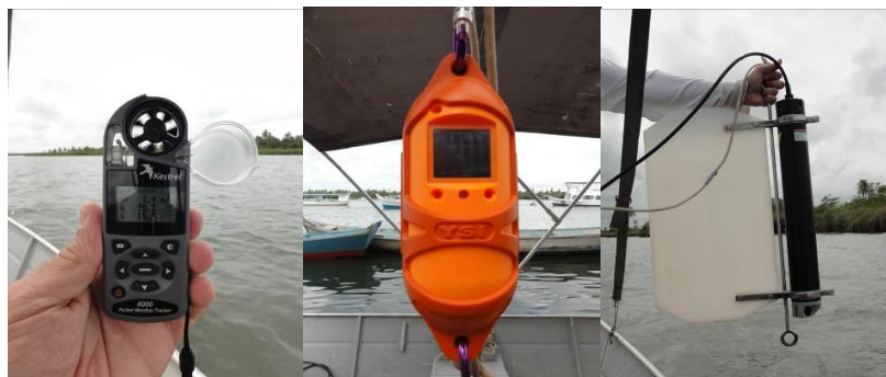
Figura 4.1 – Instrumentos empregados na mensuração de variáveis meteorológicas e hidrológicas: mini-estação Kestrel (esquerda), mini-CTD YSI CAstAway (meio) e correntômetro Aquadopp modelo AQD 5776 (direita).
