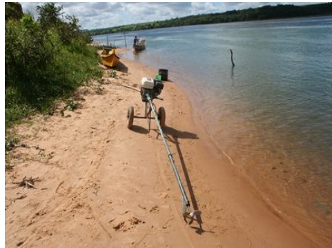
Figura 6 - "Motor de Rabeta" empregado nas embarcações da região.
