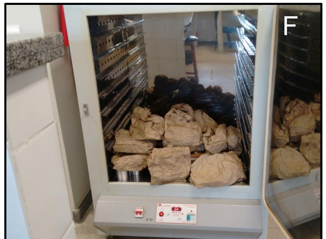
Figura 2. Coletas de biomassa nos bancos de macrófitas aquáticas monitorados (A, B, C), triagem da biomassa e separação das amostras por espécie (D), acondicionamento dos exemplares biológicos em sacos de papel madeira (E), secagem em estufa a 70°C por 72 horas (F).
