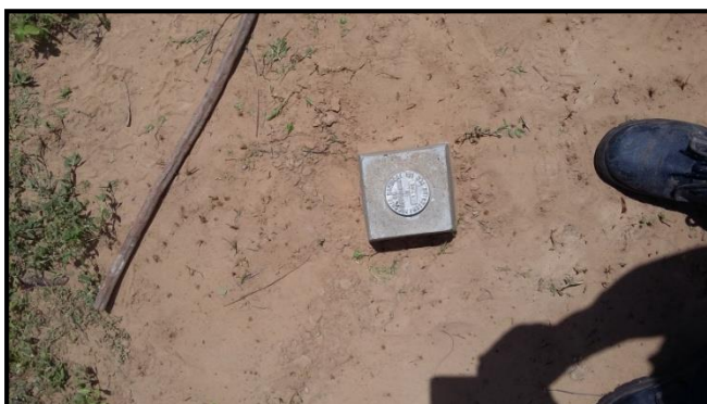
Figura 2.2. Marcos de concreto utilizados na demarcação das áreas de monitoramento dos Processos Erosivos.
