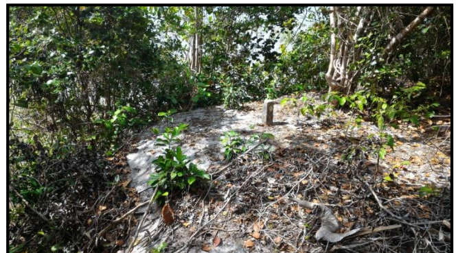
Figura 2.2. Marcos de concreto utilizados na demarcação das áreas de monitoramento dos Processos Erosivos.
