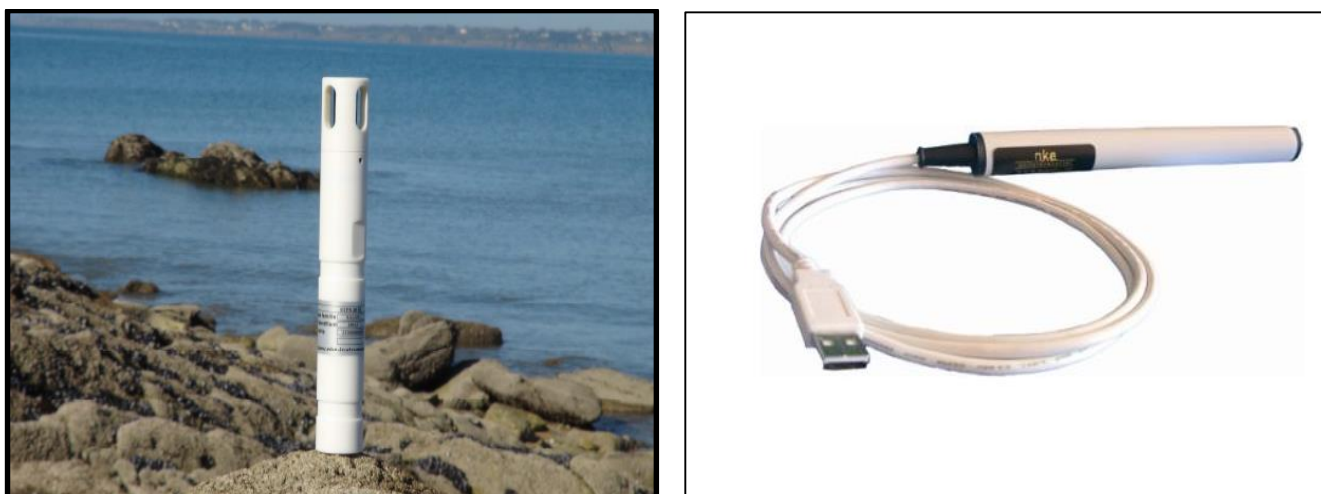
Figura 4. CTD modelo STPS30 (painel esquerdo) e comunicador óptico para programação e download dos dados (painel direito).
